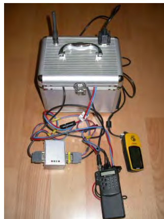
Bild 6: Beispiel für eine Integration von TinyTrack, Funkgerät, GPS, Bleiakku in einen Alu-Koffer mit Gummiwendelantenne
