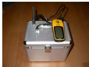
Bild 6: Beispiel für eine Integration von TinyTrack, Funkgerät, GPS, Bleiakku in einen Alu-Koffer mit Gummiwendelantenne
